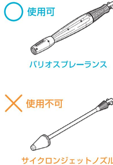
使用するノズル種類に関わらず、吐出される高圧水がカバーガラスとアルミフレーム枠の間に存在するブチル等を損傷し、水分に対するシール性能を低下させてしまう可能性があります。そのため、フレーム付近には高圧水があまり掛からないようにします。
